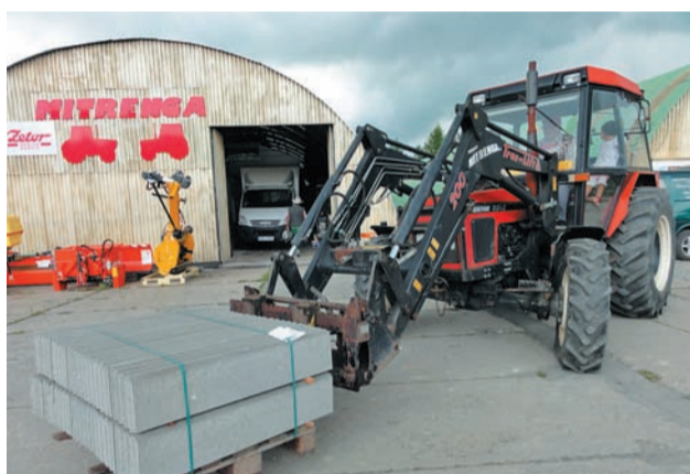
Deformace obvyklého traktorového pláště při zátěži 600 kg na čelním nakladači bez protizávaží
